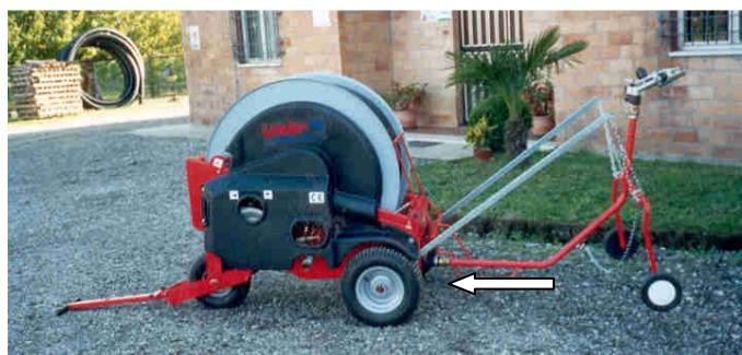
**9.** Durante l'irrigazione il Leader 40 riavvolge completamente il tubo. Il contatto con il carrello portairrigatore provoca la fine dell'irrigazione.
