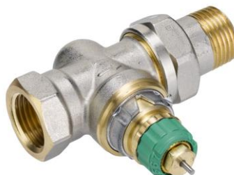
RA-DV - radiatorafsluiter met geïntegreerde drukverschilregelaar en flowbegrenzing
